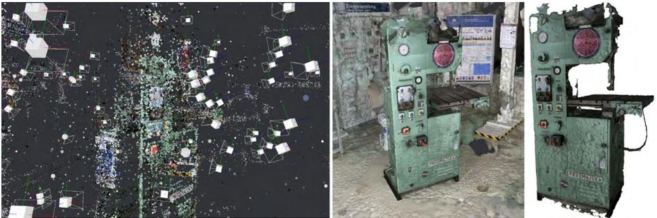
Abbildung 4: links: berechnete Kamerapositionen und Punktwolke, mittig: Ergebnis der Rekonstruktion, rechts: bereinigtes Ergebnis
