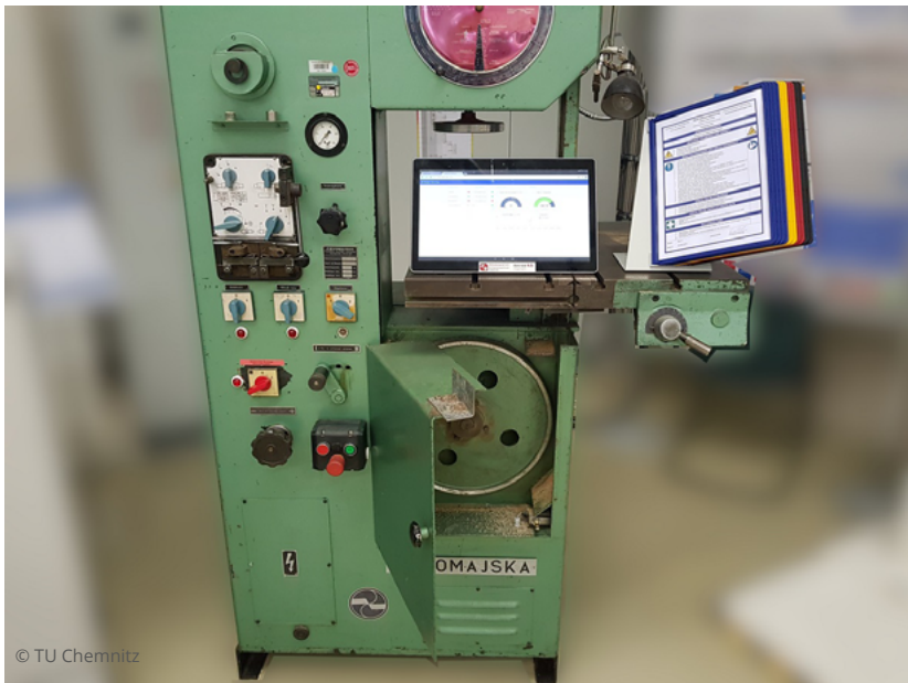
Abb. 2: Smarte Bandsäge zur Erhöhung der Arbeitssicherheit
